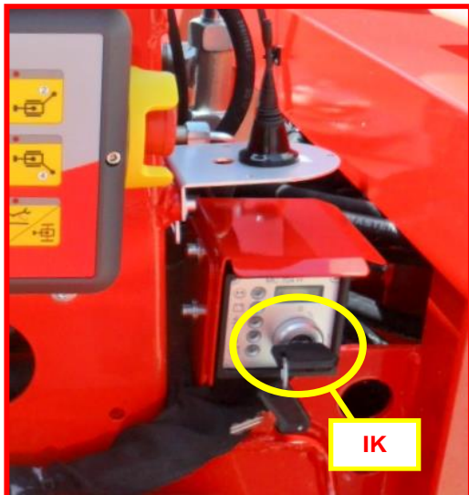
Figure 4 : poste pour marche/arrêt du moteur.
