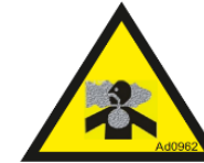
Figure 64 : risque de gaz d'échappement.
