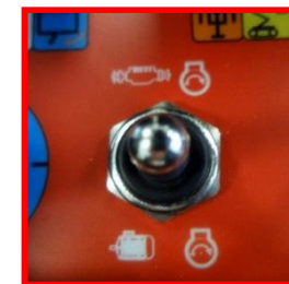
Figure 5 : levier marche/arrêt du moteur à combustion interne/électrique sur la radiocommande.
