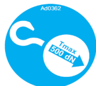
Figure 72 : points d'attache pour soulever PEMP.
